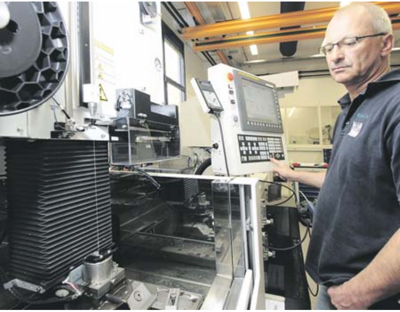
Ohne Computer geht nichts: Mitarbeiter Jürgen Rauscher an der Drahterodier-Maschine.
