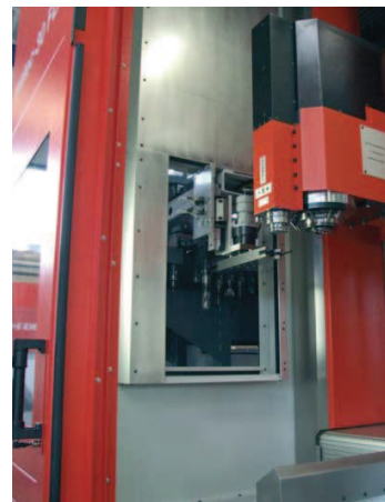
Aus dem an der matec-30 FDZ seitlich angebauten Werkzeugmagazin mit 80 Plätzen werden die Werkzeuge im Pick-up Verfahren wahlweise in die Motorspindel oder in die feststehende Spanneinheit vor der Motorspindel eingewechselt.
