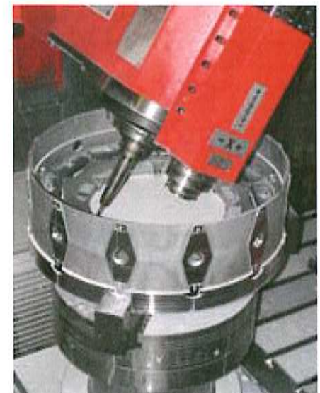
Bearbeiten eines Schaltrades aus Aluminiumguss für einen Rundtaktautomaten
