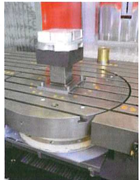
Durch den in den Maschinentisch asymmetrisch und bündig integrierten NC-Rundtisch kann die Maschine höchst flexibel eingesetzt werden
