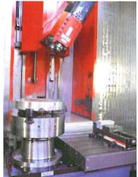
Die Drehspindel des Fräs-Drehzentrums matec-30 FDZ ist für 70 KW und 2800 U/min ausgelegt...
