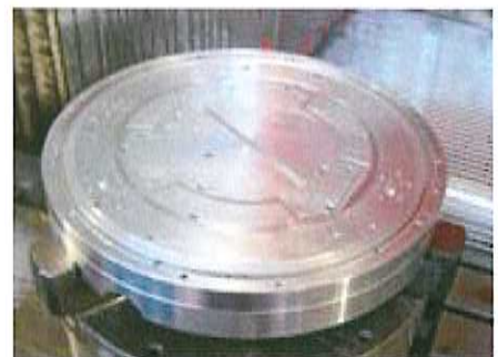
... und mit einem speziellen Spannutter für extrem niedrige Spannkräfte ausgerüstet
