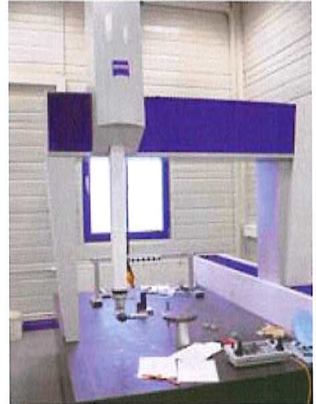
100% Kontrolle auf einer hochgenauen Koordinatenmessmaschine von Zeiss gehört bei Kappler zum Standard
