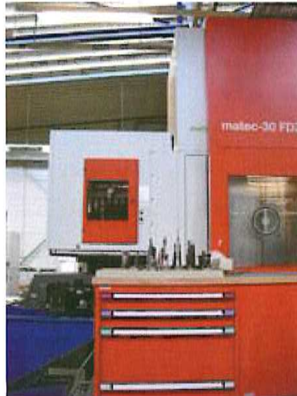
Aus dem seitlich angebauten Werkzeugmagazin mit 80 Plätzen werden die Werkzeuge mit HSK 63 Aufnahme ...
